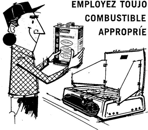
Utilisez seulement du combustible Coleman ou du naphte. N'utiliser jamais des combustibles contenant des compositions plombées ou d'huiles de graissage, parce que des matières dans l'essence qui ne vaporisent pas bloquent de carbone le générateur de votre poêle. C'est la sorte de combustible que vous utilisez qui détermine principalement la durée de votre poêle et de votre générateur.
