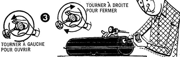
(3) de deux tours complets à gauche. Mettez le pouce sur le petit trou de la poignée et pompez à fond de 35 à 50 fois pour remplir le réservoir d'air. Puis, tournez la poignée du piston de la pompe à droite et serrez-la fermement.
