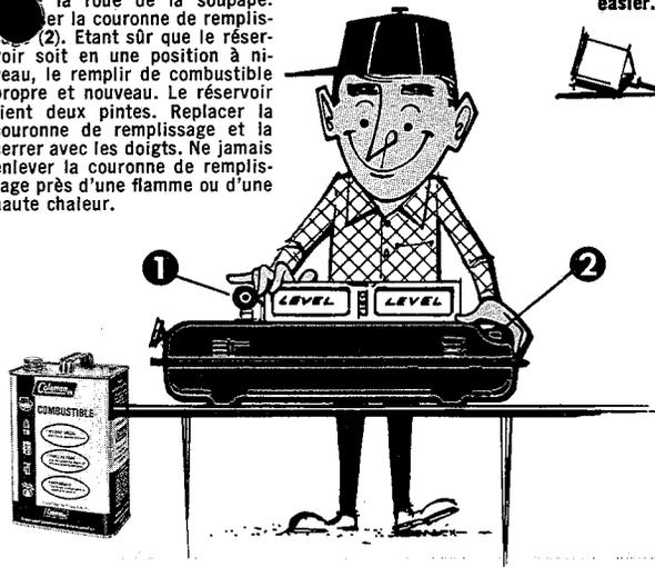
**POUR POMPER.** La soupape du générateur et le bouchon de remplissage doivent être bien serrés. Tourner à gauche deux tours com-
