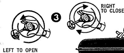
plets la poignée du plongeur de pompe (3). Placer le pouce en travers le petit trou dans la poignée et pomper 35 à 50 coups d'air dans le réservoir. Alors tourner à droite la poignée du plongeur de pompe et la serrer.
